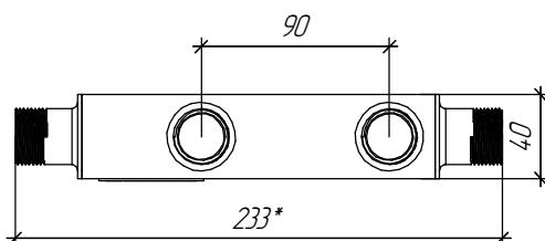
\* Используется для разметки отверстий кронштейнов
